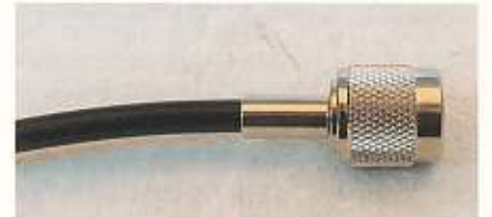
RP-TNC, de huls wordt over de draadjes van de mantel geschoven.
